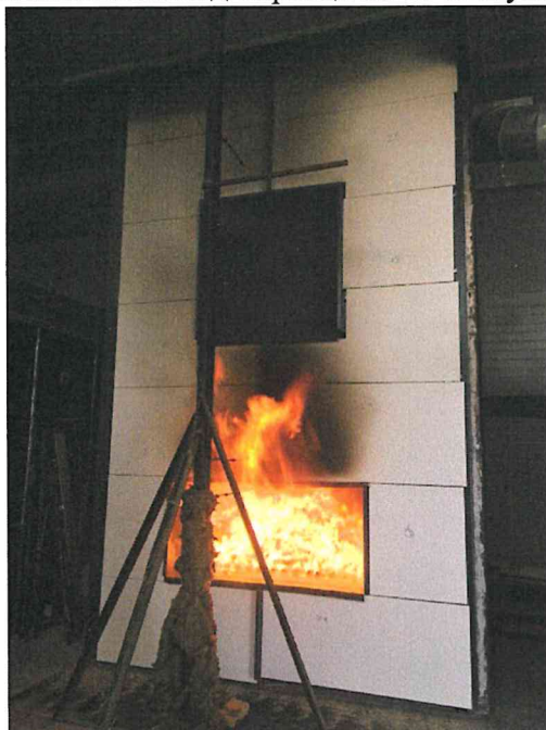
Рис. 6. Внешний вид образца на 45 минуте испытаний.
